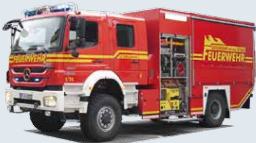
Der GW-L des Aufbauherstellers Hensel mit seinem wuchtigen 4x4-Fahrgestell ist ein Hingucker – aufgebaut mit Staffelnkabine und Ladebordwand.
