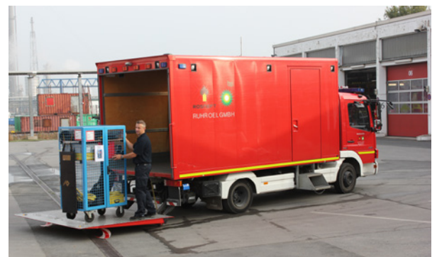
Am Standort Scholven der Werkfeuerwehr ist ein Gerätewagen-Logistik (GW-L) stationiert. Über die Ladebordwand können Rollcontainer mit unterschiedlicher Ausstattung in den GW-L eingeladen werden.
