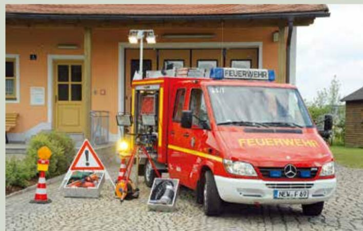
Das TSF der Feuerwehr Göschenreuth. Der Mercedes Sprinter 314 mit Aufbau von Furtner & Ammer stammt aus 2003. Das TSF besitzt neben der Normbeladung noch einen Stromerzeuger, einen Lichtmast mit zwei 500-Watt-Scheinwerfern sowie einen Beleuchtungssatz.
