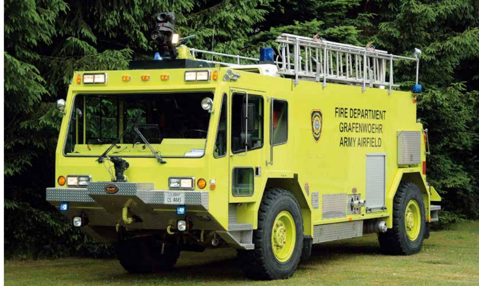
Auf einem KME ARFF 1500 ist das FLF 76/57-8-2,5 von Kovatch aus dem Jahr 1999 aufgebaut. Dieses Fahrzeug hat 5 700 Liter Wasser, 800 Liter Schaum und 250 Kilogramm Pulver als Löschmittel zur Verfügung. Die Pumpe leistet 7 570 Liter in der Minute bei maximal 15,1 bar. Das Gesamtgewicht des FLF beträgt 21 Tonnen.
