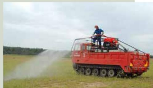
Einsatz für den Löschpanzer. Die Besatzung besteht aus Fahrer und Strahlrohrführer. Während der Fahrer grundsätzlich das Steuer nicht verlässt, löscht der Strahlrohrführer von einer Plattform über dem Wassertank mit einem C-Rohr die Flammen ab. Durch die mitgeführte TS 8/8 kann der Panzer völlig eigenständig arbeiten.
