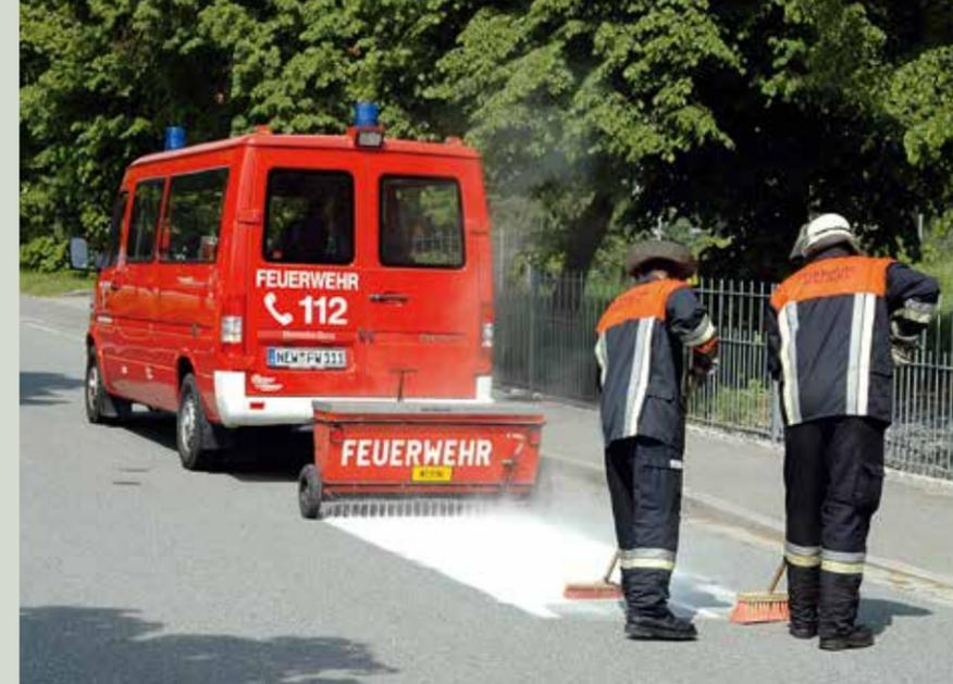
Die Ölspurbeseitigung gehört zu den unbeliebtesten Aufgaben bei der Feuerwehr. In Grafenwöhr kommt der von den Kameraden selbstgebaute Streuwagen zum Einsatz.
