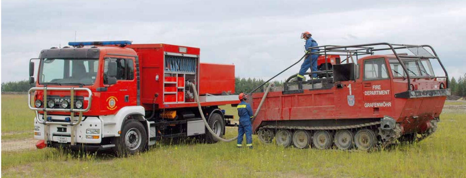
Ist der Wasservorrat des Löschpanzers verbraucht, wird er vor Ort wieder befüllt. Der US-Feuerwehr stehen hierfür zwei Abrollbehälter mit jeweils 6 000 Liter Wasser zur Verfügung, die durch das WLF transportiert werden.
