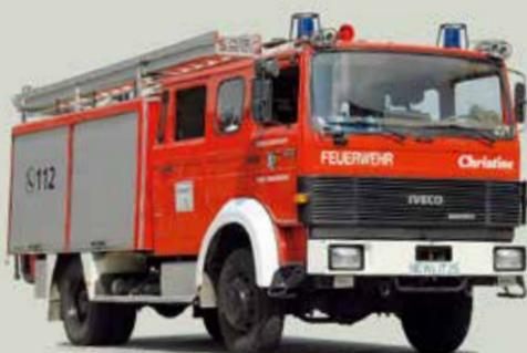
Aus dem Jahr 1987 stammt das LF 16. Der Iveco 120-190 ist mit einem Rettungssatz ausgerüstet. Der Löschmittelvorrat beträgt 1 200 Liter Wasser und 120 Liter Schaummittel.
