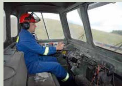
Alexander Richter am Steuer eines der Löschpanzer. Zum Steuern steht ihm – wie in einem Flugzeug – nur ein „U“ zur Verfügung. Schalten muss er allerdings nicht. Die Panzer besitzen ein automatisches Getriebe. Wegen des immensen Geräuschpegels im Inneren fährt Richter den Löschpanzer mit Gehörschutz.
