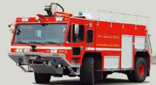
Das FLF 24/35-3-7,5 auf einem Faun 22.30/45V ist identisch mit den Feuerlösch-Kfz 3500 der Bundeswehr. Neben 3 500 Liter Wasser sind 300 Liter Schaum und 750 Kilogramm Pulver in den Tanks des von Bachert und Ziegler 1984 gebauten Fahrzeugs.
