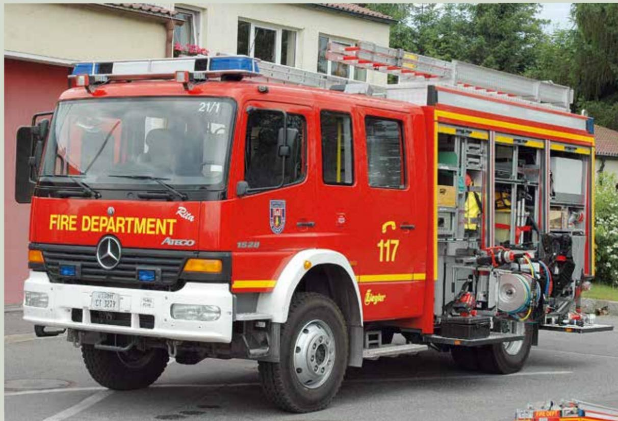
Das HTLF 28/30-5 ist der Allrounder der US-Feuerwehr. Es rückt beinahe zu jedem Einsatz mit aus. Der Mercedes Atego 1528 aus dem Jahr 2002 hat einen Aufbau von Ziegler. Ein Rettungssatz, Wärmebildkamera und Wasserauger gehören ebenso zur Beladung wie ein Notfallrucksack, ein Gerätesatz Absturzsicherung und ein Lüfter.
