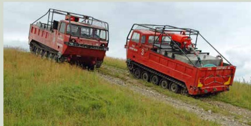
Zwei Löschpanzer auf Einsatzfahrt im unwegsamen Gelände des Übungsplatzes. Bei Wald- und Flächenbränden sind diese höchst geländegängigen Fahrzeuge für die Lagerfeuerwehr unverzichtbar. Auch Steigungen oder Böschungen stellen für die Panzer keine großen Hindernisse dar.
