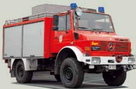
Als Rüstwagen steht ein RW 1 auf dem schweren Unimog-Fahrgestell, Typ U 1550 L, zur Verfügung. Der 1993 von Ziegler gebaute RW ist mit einem Rettungssatz, Mehrzweckzug, Beleuchtungssatz und einem eingebauten Stromerzeuger ausgerüstet.
