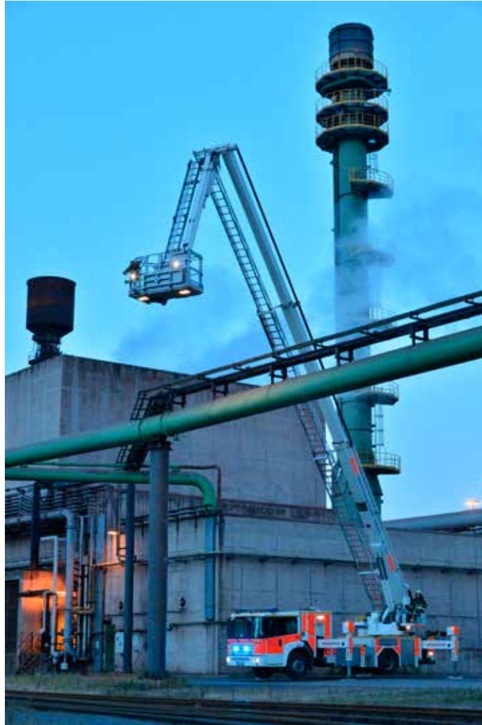
Als Hubrettungsfahrzeug dient der Werkfeuerwehr Salzgitter AG diese 32-Meter-Teleskopmastbühne auf Mercedes Econic 1828 LL. Metz fertigte den Aufbau im Jahr 2006.
