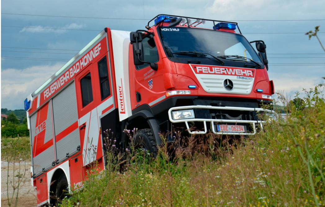
Dank großer Rampen- und Böschungswinkel klettert der U 20 mühelos durch unwegsames Terrain.
