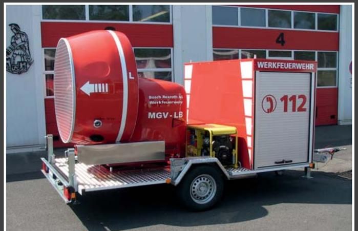
MGV L125 auf 1,6t-Anhänger mit Kofferaufbau
