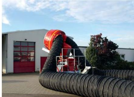
Saugbetrieb mit Spiralschlauchsystem
