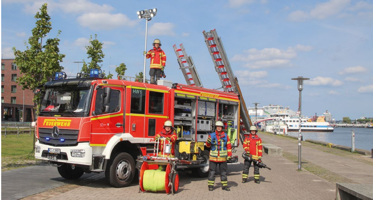
Neueste Löschfahrzeuge der BF Kiel sind zwei von Schlingmann auf Mercedes-Benz Atego 1627 AF gebaute HLF 20.
