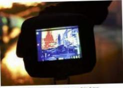
Das Bild zeigt die Wärmebildkamera im Einsatz. Sie wird auch für die Erkennung von Personen in der Dunkelheit eingesetzt.
