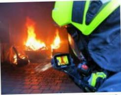
Die Wärmebildkamera Feuerwehler kann bei der Arbeit im Innenangriff eingesetzt werden. Foto: Bullard
