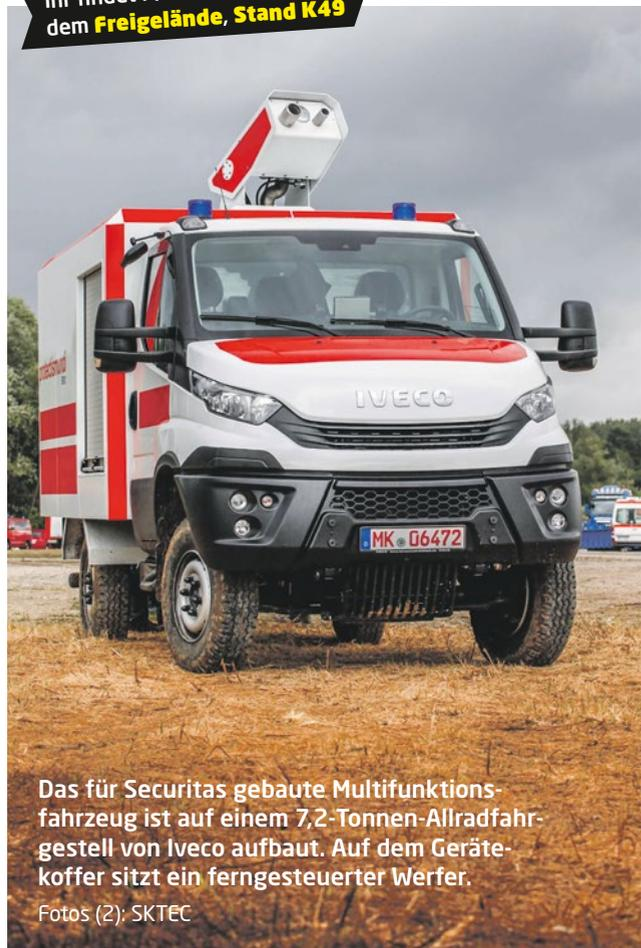
Das für Securitas gebaute Multifunktionsfahrzeug ist auf einem 7,2-Tonnen-Allradfahrzeug von Iveco aufgebaut. Auf dem Gerätekofer sitzt ein ferngesteuerter Werfer.
