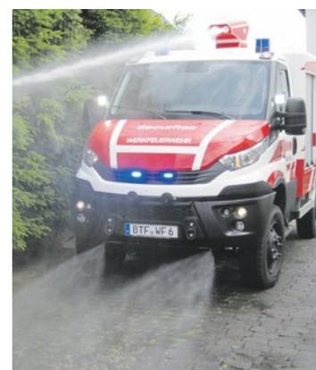
Neben dem Werfer verfügt das Fahrzeug für den Eigenschutz oder die Reinigung von Fahrbahnen auch über Frontsprühdüsen.
