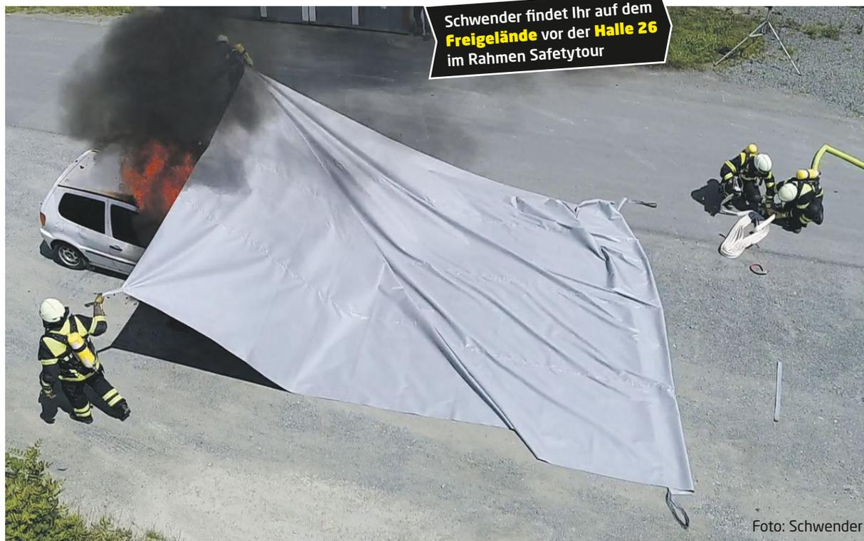
Innerhalb von Sekunden ist die Viltex-Feuerlöschdecke über einen brennenden Pkw gezogen. Sofort lässt die Rauchentwicklung nach.
