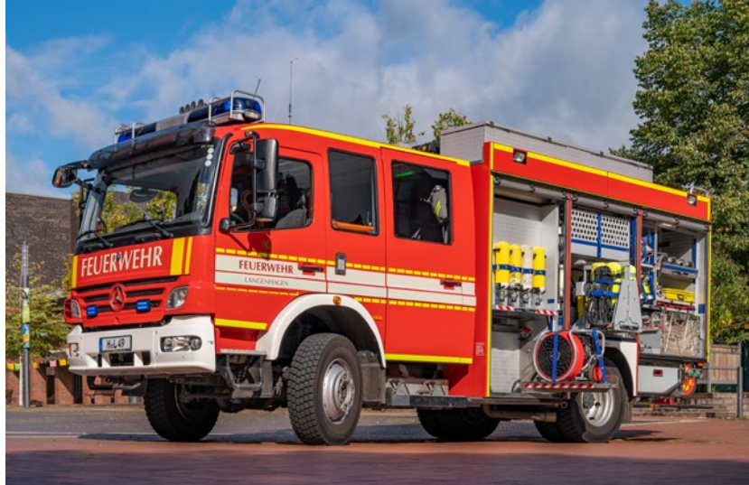
TLF 20/25 der Ortsfeuerwehr Langenhagen, 2009 von Schlingmann auf Mercedes Atego 1329 AF ausgeliefert. Es dient als Erstangriffsfahrzeug bei Brandeinsätzen.
