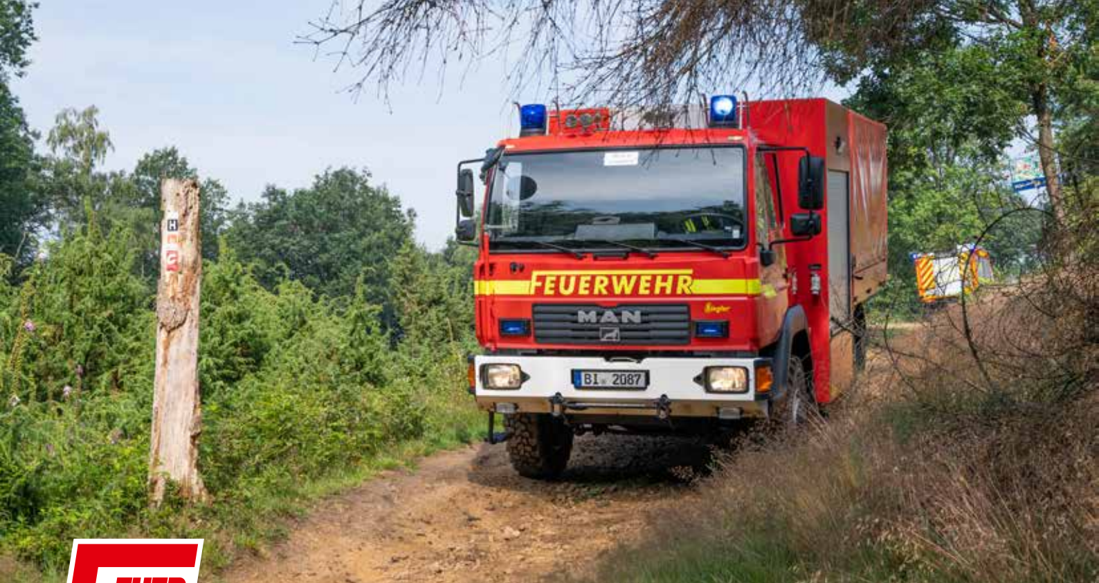
Schlauchwagen (SW) 2000 der LA Großdorn- berg auf MAN LE 10.180 4x4 von Ziegler, Baujahr 2006.
