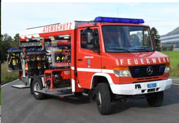
Atemschutzfahrzeug (ASF) der FF Schaan auf Mercedes Vario 814 DA. Marte hat das Fahrzeug 1997 gebaut. Es ist bis unters Dach mit Atemschutzausrüstung beladen.
