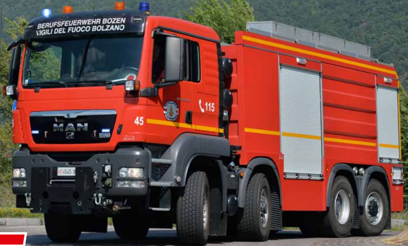
Eines von zwei TLF 12000/1000 auf MAN TGS 25.540 8x6H der BF Bozen. Foto: M. Ruffer
