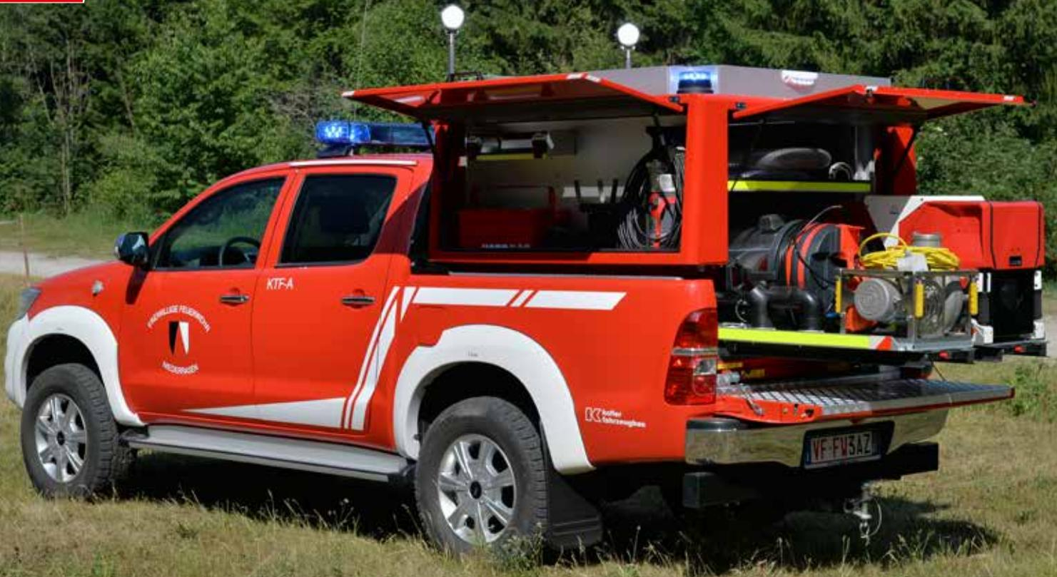
Auf einem Pick-up Toyota Hilux Double Cab 3.0 D-4D basiert das KTF-A der FF Niederrasen (Südtirol, Italien). Besonderheit des Kofler-Aufbaus: ein Wechselcontainer-System auf der Ladefläche.
