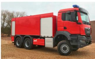
**GTLF 10000, MAN TGS 26.360 Allrad 6x6**, Tipmatic, PE-Tank, Aufbau 3-tlg., ALCO-Werfer, FP 10-3000 Johstadt, Neufahrzeug, ab Lager freibleibend.
