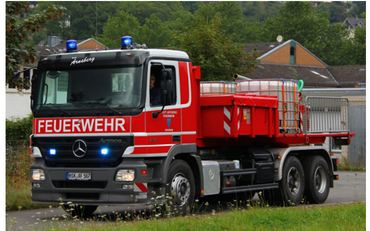
Das WLF der Hauptwache ist ein Mercedes Actros 2541 mit Meiller-Aufbau von 2007. Hier aufgesattelt ist der AB-SWW (Schaummittel/Wasserwerfer).
