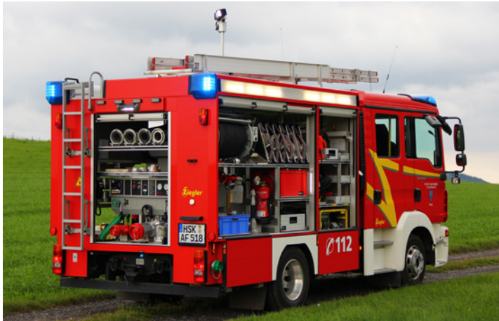
Ein MAN TGL 8.180 bildet die Basis für das 2011 beschaffte TSF-W der Löschruppe Holzen mit Heckpumpe und Tragkraftspritze.
