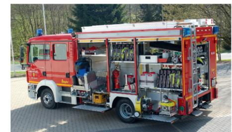
Die FF Burbach (NW) setzt dieses bei Ziegler in Mühlau gebaute MLF auf MAN TGL 10.250 ein. In dem dreigeteilten Geräteaufbau lagern ein 13-kVA-Stromerzeuger, Löschmittel für Metallbrände, Überdrucklüfter, Wassersauger und Chiemseepumpe.
