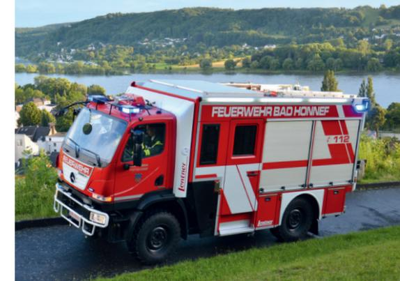
Auf Unimog U 20 fertigte Lentner das MLF der LG Rhöndorf, FF Bad Honnef (NW). Überdrucklüfter, Mini-Chiemseepumpe, die Gerätesätze Strom, Beleuchtung, Motorsäge und Schaum sowie ein Wasserwerfer und zwei Multifunktionsleitern gehören zur Beladung.
