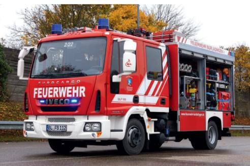
Auf einem abgelasteten 10-Tonnen-Fahrgestell (Iveco 100 E 18 D) ließ sich die FF Burladingen (BW) ihr neues MLF von Magirus aufbauen. Der Wassertank fasst 700 Liter.
