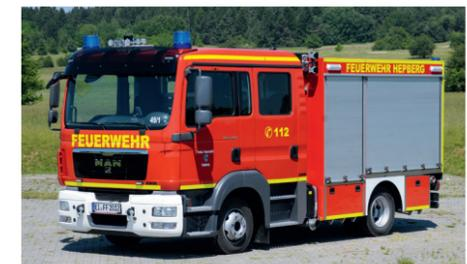
Adik baute das MLF der FF Hepberg (BY) auf einem MAN TGL 8.180 auf. Vor der Aufbauwand ist ein Lichtmast mit vier Scheinwerfern montiert. Zur Beladung gehören 2x Gerätesatz Absturzicherung, Nasssauger sowie die Beladungssätze Motorsäge, Strom und Schaum.
