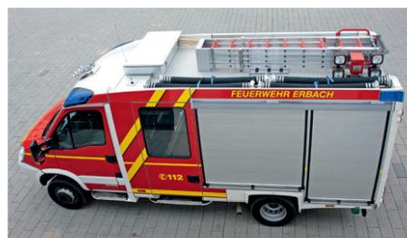
Das erste von Iveco Magirus gebaute MLF auf einem Allradfahrgestell ging an die Abteilung Ringingen der FF Erbach (BW). Auf dem Dach des Iveco Daily 70 C 17 4x4 lagern Saugschläuche, Steckleiter sowie Handwerkzeug. Zudem ist ein Teklite Light Robot-Lichtmast mit vier Xenon-Scheinwerfern zu sehen.
